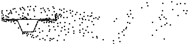
Fig. 3 : Vue instantanée du sillage du viaduc représenté par des tourbillons.
