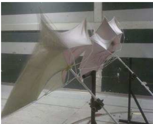
Fig. 2 : Déformations des parasols à 45° dûes au vent.
